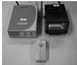
アラートマスター(左)・フラッシュライト(右)ドアベル(中央)
